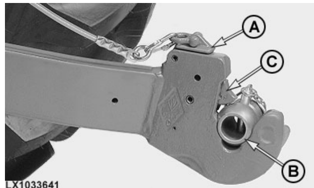
Работа с крюком зацепа через тросик управления
